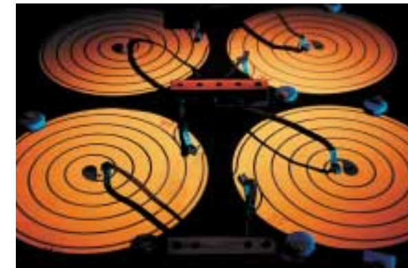
Supraleitende Strombegrenzer können potentiell verheerende Stoßströme niedrig halten, wie sie etwa bei Kurzschlüssen auftreten. (Quelle: Siemens)
