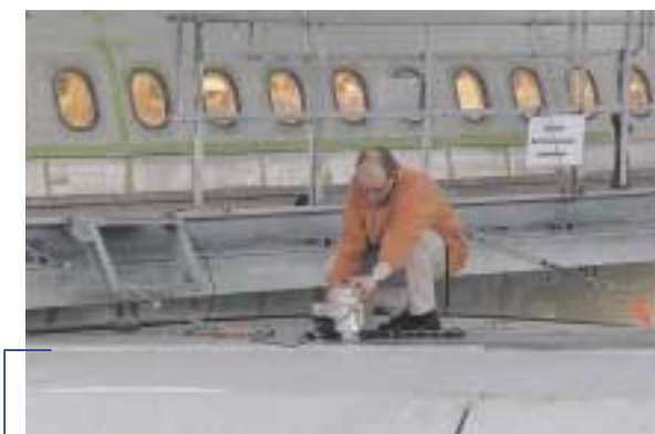
Sicherheitskontrolle vor Ort: SQUIDS (Supraleitende Quanteninterferenz-Detektoren) werden unter anderem zur Materialprüfung eingesetzt. Mit ihnen lassen sich verborgene Risse in der Außenhaut von Flugzeugen aufspüren. (Quelle: FZ Jülich)
