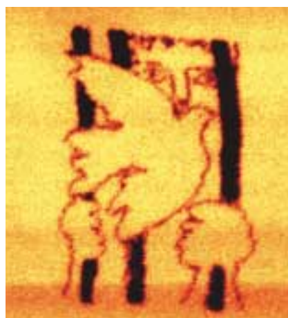
Dieser Picasso ist fünfmal schmäler als ein Menschenhaar. Das Muster wurde mit einem optischen Sondenmikroskop „gezeichnet“ und mit einem Kraftmikroskop abgebildet. Auf der Fläche dieses Picassos ließe sich die molekulare Millenniumszahl millionenfach unterbringen. (Quelle: Physikalisches Institut der Uni Münster)
