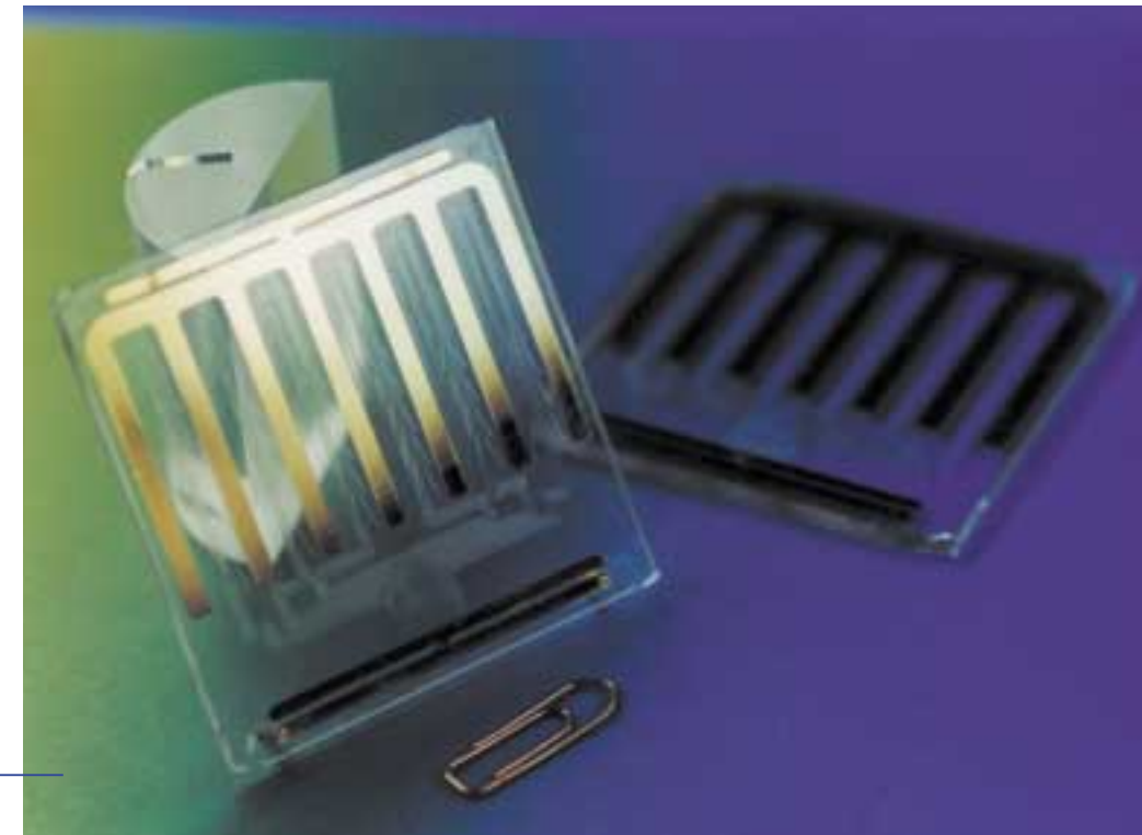
Dieses „Chip-Labor“ trennt biologische Proben in ihre Bestandteile auf – und zwar mit Hilfe elektrischer Felder. Über einen angeschlossenen Computer kann der Chip bis zu 96 flüssige Substanzgemische nahezu gleichzeitig analysieren,
